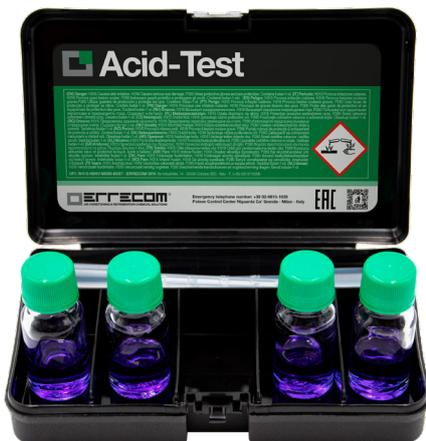
ACID-TEST è un prodotto indispensabile per individuare la presenza e la formazione dell'acido all'interno degli impianti di climatizzazione e refrigerazione. L'utilizzo di ACID-TEST è un passaggio molto importante in una regolare manutenzione preventiva e fornisce un metodo veloce ed accurato per rilevare la presenza di acido nei lubrificanti.
